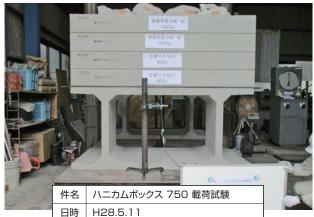
③死荷重(土被り0.5m) +車両荷重10kN/㎡ W=19.5kNm<sup>\*</sup>
